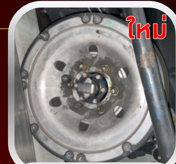
เหล็กหล่อขึ้นรูป และเพิ่มแหวนกันหล่น
